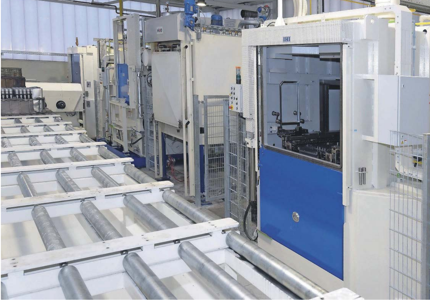
Elektrisch betriebene Wärmekammer und temperiertes Ölbad bilden ein geschlossenes und sauerstofffreies System. Bild: Schmahl
